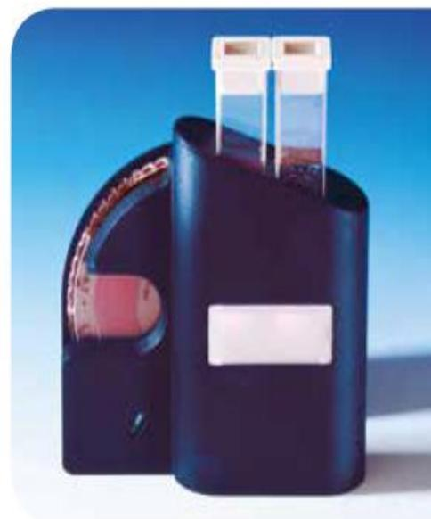
Vue de l'arrière du comparateur CHECKIT®, avec disque, plaque de diffusion et cuvettes
