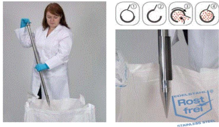
Le scratcher est spécialement conçu pour le prélèvement de substances collantes agglomérées et non coulantes.
