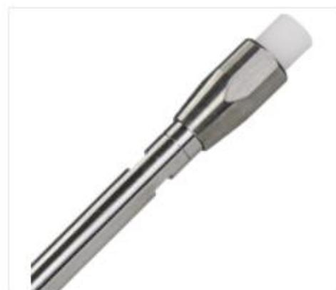
Colonne HPLC EC (analytique), NUCLEODUR 100-5 NH2-RP, 5 µm, 250x4 mm
