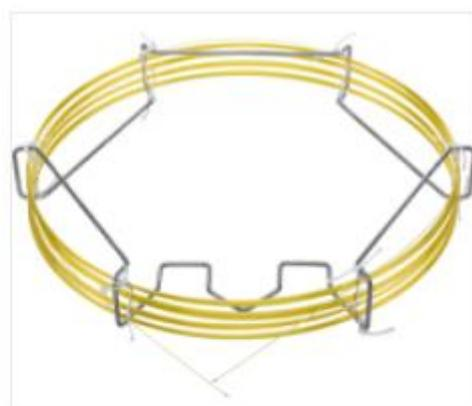
Colonne de CPG, faible/moyen. polaire OPTIMA 1701, 25 m L, 0.53 mm DI, 2 µm ef
