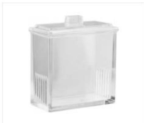
CCM cuve de dvpmt, jusqu'à 5 plaques/feuille simultanées, format max. 20x20 cm
