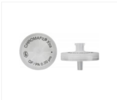
Filtres seringue (combi), CHROMAFIL Xtra GF / PA, 25 mm, 1  $\mu$ m / 0.2  $\mu$ m
