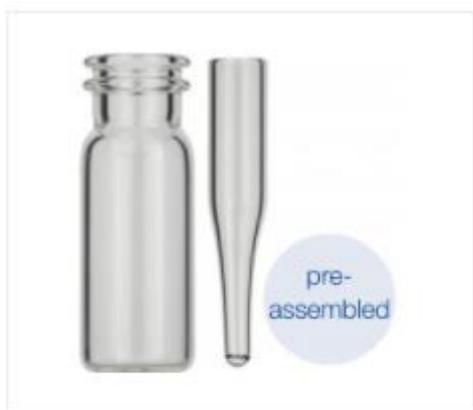
Flacons à capsuler/visser, N11 (702714) avec insert conique intégré (702813)
