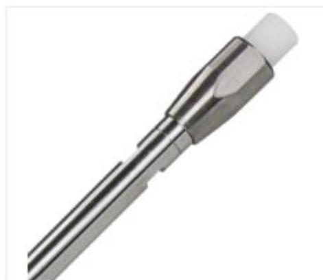
Colonne HPLC EC (analytique), NUCLEODUR 100-5, 5 µm, 250x4 mm
