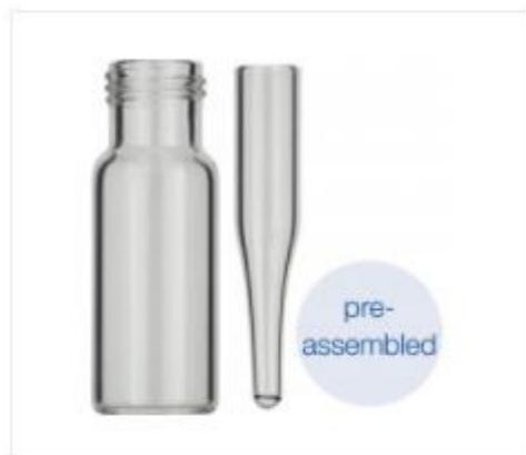
Flacons à vis N 9 (702282) avec insert conique intégré (702813)
