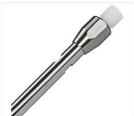
Colonne HPLC EC (analytique), NUCLEOSIL 100-5 C8, 5 µm, 125x4 mm
