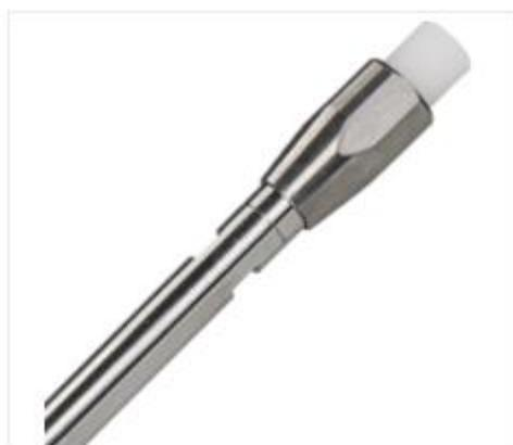
Colonne HPLC EC (analytique), NUCLEODUR 100-3, 3 µm, 250x4.6 mm
