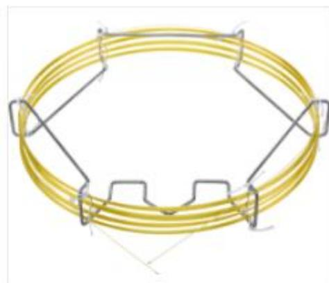
Colonne de CPG, polaire, PERMABOND CW 20 M, 25 m L, 0.32 mm DI, 0.25 µm ef
