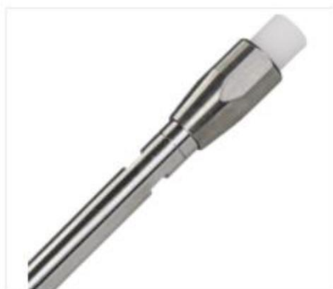
Colonne HPLC EC (analytique), NUCLEODUR C18 lais, 3 µm, 250x4 mm
