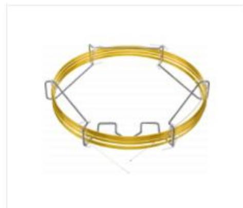
Colonne de CPG, apolaire, OPTIMA 1, 50 m L, 0.53 mm DI, 2  $\mu$ m ef
