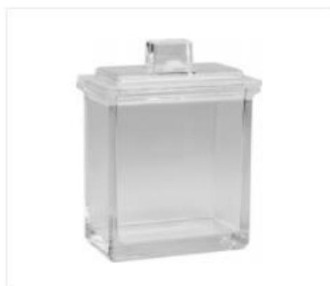
CCM cuve de dvpmt, jusqu'à 2 plaques/feuille simultanées, format max. 10x10 cm
