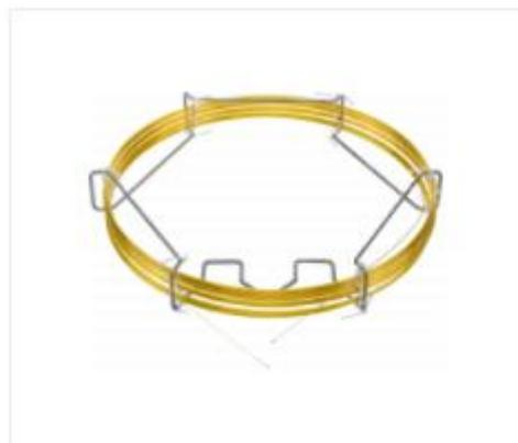
Colonne de CPG, apolaire, OPTIMA 1, 60 m L, 0.25 mm DI, 1  $\mu\text{m}$  ef
