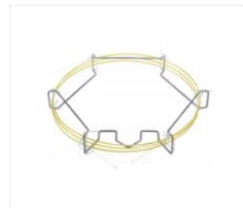
Colonne de CPG, apolaire, OPTIMA 1, 10 m L, 0.32 mm DI, 0.1  $\mu$ m ef
