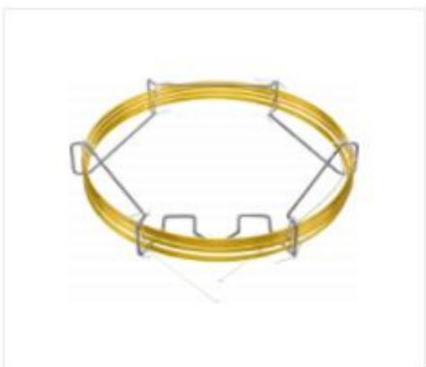
Colonne de CPG, apolaire, OPTIMA 1, 60 m L, 0.32 mm DI, 3  $\mu\text{m}$  ef
