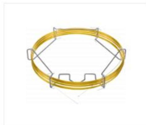
Colonne de CPG, apolaire, OPTIMA 1, 60 m L, 0.25 mm DI, 0.5  $\mu$ m ef
