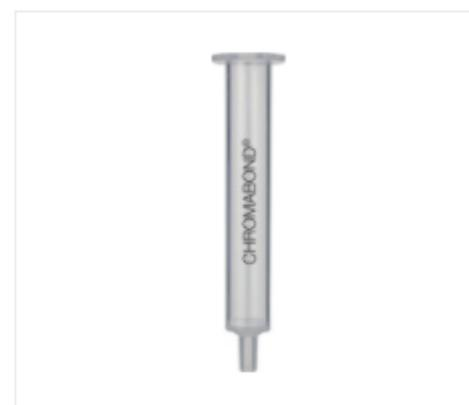
Colonnes CHROMABOND vides, 3 mL, polypropylène, avec éléments filtrants en PE
