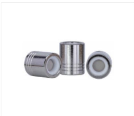
Précolonne HPLC EC (analytique), NUCLEOSIL 100-5 C8, 5 µm, 4x3 mm
