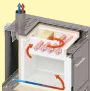
Schéma de principe du flux d'air dans le four d'incinération L 24/11 BO
