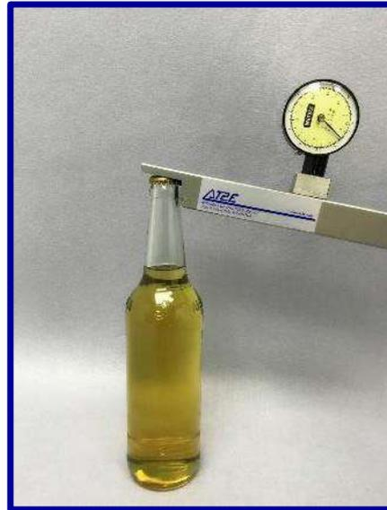
Le CCOT-1 Crown Cap Opener Tester est un appareil de mesure de force. Il a été conçu spécialement pour l'industrie des capsules de bouteilles. Facile à utiliser, il permet de mesurer l'insertion ou le débouchage de la capsule pour améliorer les processus de fabrication et de scellage.
