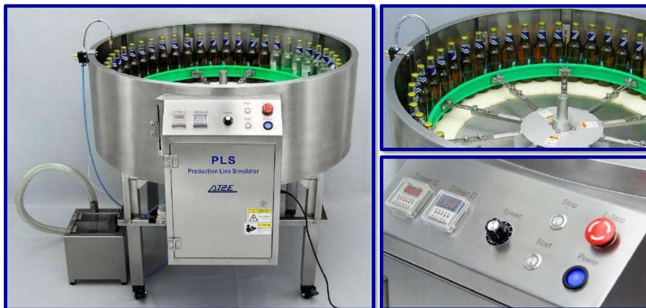
Le simulateur de ligne de production PLS permet de simuler de manière reproductible et accélérée le frottement sur une ligne de conditionnement.
