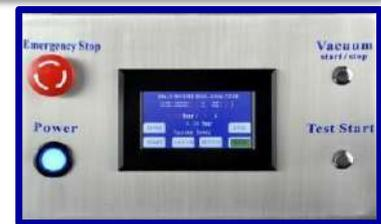
Le SSA ECO est un appareil qui permet la mise en pression et détermination du point de fuite ( point de bulle ). Grâce à l'aiguille brevetée AT2E utilisant la technologie de maintien par le vide, l'utilisation est très facile et l'installation sur tous supports possibles : PET, couronnes, films, cannettes, corps de bouteilles, autres... L'aiguille standard ( vissée ) permet la mise en pression avec des temps de maintien longs à des valeurs intermédiaires.
