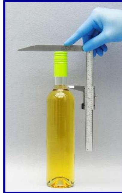
Utilisation très simple. La toise peut être prédéfinie en pouces ou en millimètres pour vérifier le niveau de remplissage sur la ligne de production ou peut être utilisée pour mesurer le point de remplissage précis de la bouteille, puis par rapport à la norme. La règle peut être élevée ou abaissée pour compenser l'épaisseur des couronnes différentes
