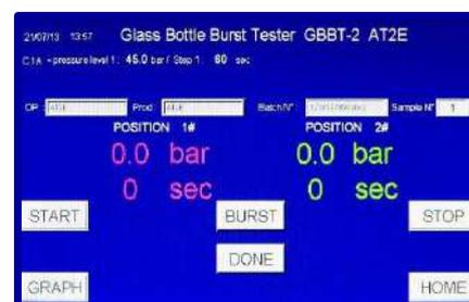
Le GBBT-2 est un instrument pour tester la résistance à la pression dans les récipients en verre.
