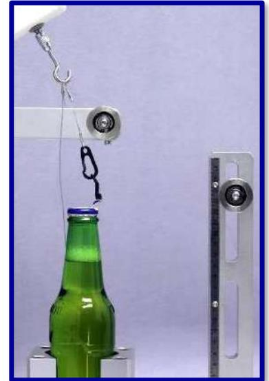
POT-1 a été étudié et développé pour pouvoir ouvrir pas à pas les bouchons extractibles pour boissons gazeuses. Le POT-1 comprend un testeur dynamométrique précis et un cycle semi-automatique. L'angle des deux étapes est réglable. Et il a été conçu pour tester différentes hauteurs de bouteille avec bouchon.
