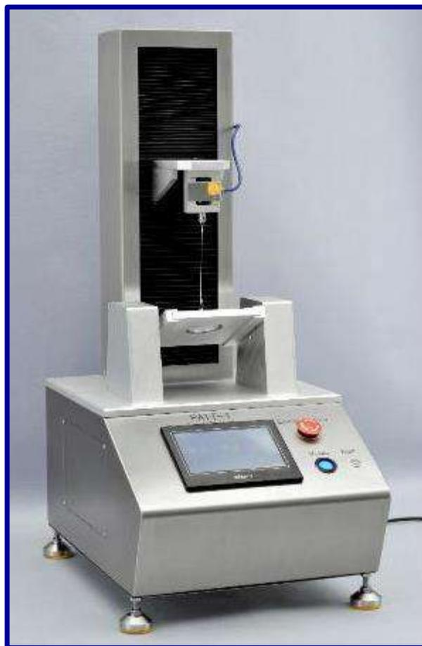
Le PATT-1 Pop and Tear Tester propose une solution simple pour l'inspection des capots à ouverture facile. Il est capable de mesurer la force d'arrachage et d'étirement de différents types d'ouvertures avec plusieurs modes de test. Il est utilisé dans les industries utilisant des boîtes / canettes.
