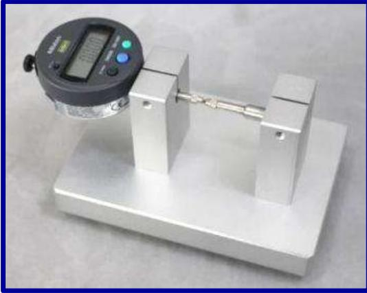
PTG -1 Permet de mesure rapidement et avec précision les épaisseurs sur différentes plaques.
