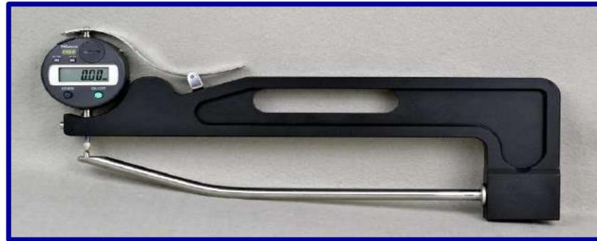
Cet appareil mesure l'épaisseur des bouteilles en verre, mais est également utilisable sur des bouteilles d'autres types. Cette jauge est constituée de la pince de mesure Mitutoyo. Ou autre sur demande.
