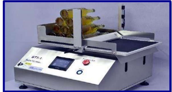
Le **Bottle Tilt Tester** est un appareil de test de résistance à l'inclinaison des bouteilles ou autres échantillons. Il est recommandé pour les industries telles que : la verrerie, la plasturgie, les boissons, et la cosmétique par exemple.
