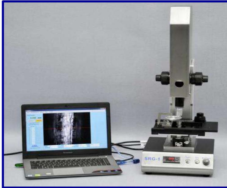
Créé avec des éléments optiques de haute précision, le SRG-1 garanti une visualisation haute définition du profil de découpe et des mesures précises. Équipé d'une lentille à distance focale élevée, l'appareil est compatible avec différents types de configuration et de position de l'échantillon.
