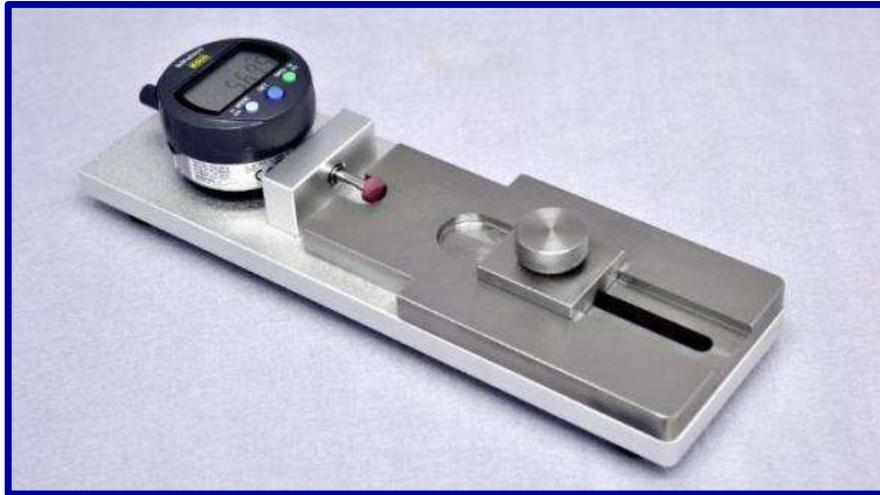
ECDG-1 mesure rapidement le diamètre de rebord des capots
