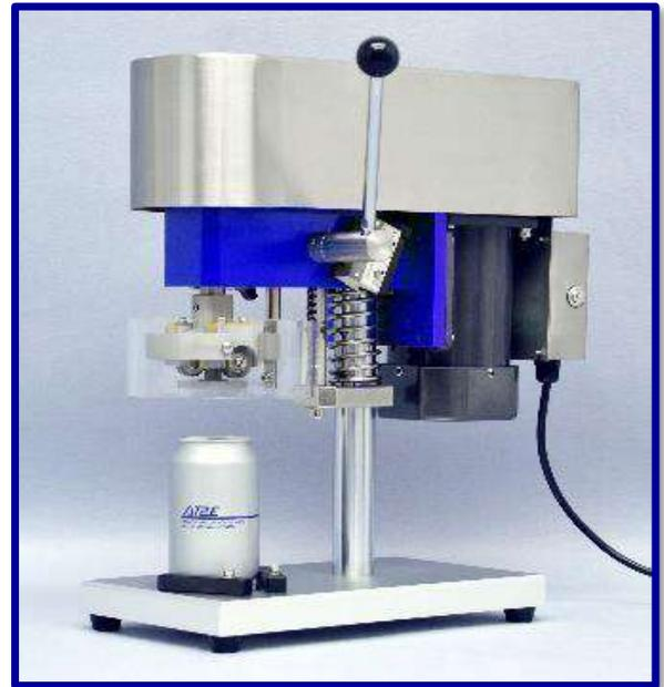
Le STR-1 Seam stripper est fait pour couper et dénuder rapidement le double serti des canettes en aluminium et en acier en un seul mouvement. Grâce à sa configuration unique et ses scies rotatives, seul le serti supérieur sera coupé. Le crochet du corps et du dessus seront en parfait état pour être mesurés et inspectés
