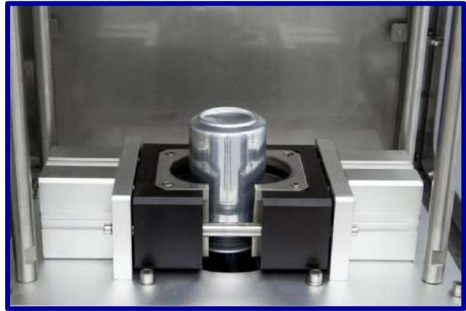
Le testeur de boucle de canette/boite AT2E CEBT a été conçu pour tester les performances de résistance à la pression du dôme et des capots de la canette, il peut également effectuer le test de missile pour les capots
