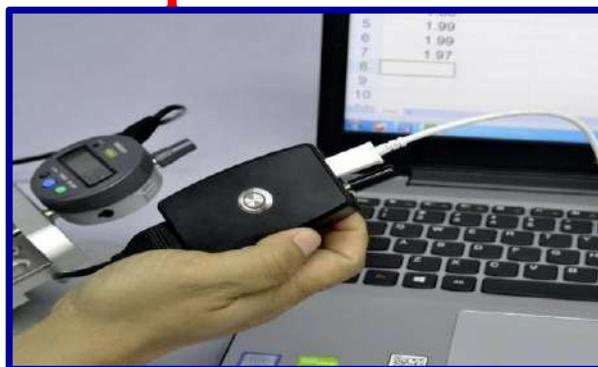
Le GDTB-1 Gauge Data Transportation Box est un boîtier de récupération et transfert des données entre les jauges Mitutoyo et nos logiciels AT2E. (**AT2E "QUALIGAUGE"**).
