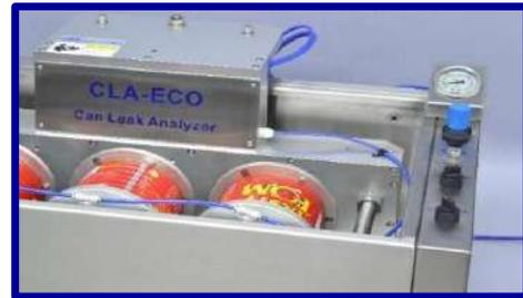
Le CLA-ECO Can Leak Analyzer a été spécialement conçu pour le contrôle de l'étanchéité des sertis sur les boîtes ou cannettes. Principalement pour les boîtes 3 parties. Le bain permet la libre rotation des boîtes et donc le contrôle à 360° du corps et de des sertis des boîtes. Des bulles apparaissent lorsqu'il y a une fuite au niveau du serti ou de la soudure sur le corps
