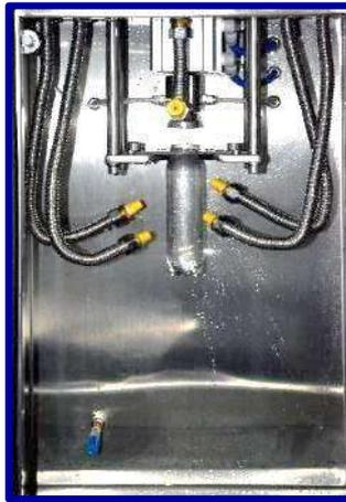
PABT avec maintien de température par projection d'eau
