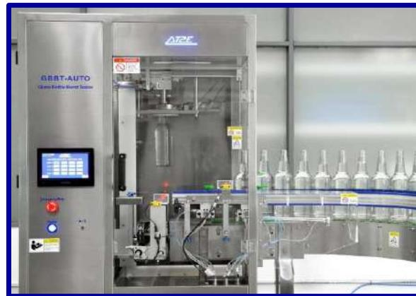
GBBT-AUTO testeur automatisé d'explosion de bouteilles en verre est un instrument entièrement automatique conçu pour tester la résistance à la pression interne des récipients en verre.
