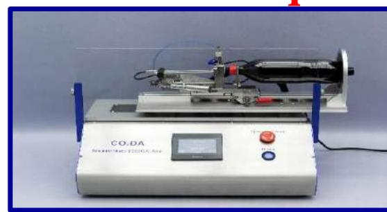
Le CO<sub>2</sub>DA – calculateur semi-Automatique de CO<sub>2</sub> est un équipement spécialement conçu pour le calcul du CO<sub>2</sub> contenu dans les boissons conditionnées dans des bouteilles en verre, en PET et cannettes. La mise en place est semi-automatique et la procédure de test est automatisée, ce qui garantit un calcul précis et 100% reproductible. La mise en place est très simple et accessible à tous.
