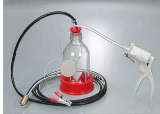
Préleveur spécialement conçu pour le prélèvement de liquides inflammables de classe de risque AI (VbF, par ex. l'essence). Le flacon en verre et le tuyau sont raccordés de façon conductrice et sont mis à la terre par un câble de masse.
