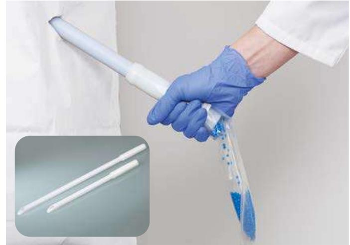
Avec l'échantillonneur à usage unique DispoLance, il est possible de prélever des quantités réduites à grandes directement dans les sacs. Le collecteur est approprié pour les poudres fluides et les granulés à petite granularité. Avec la pointe stable, l'échantillonneur DispoLance est inséré dans le récipient, l'échantillon s'écoule via le tube intérieur directement dans le réservoir ou le sac se trouvant directement en dessous.
