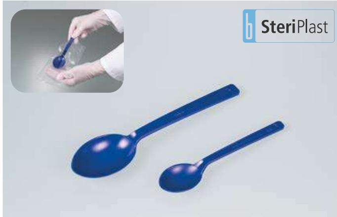
Les cuillères détectables SteriPlast® en polystyrène bleu sont fabriquées dans notre salle blanche, classe 7 (10.000), montées, emballées individuellement pour l'usage unique et stérilisées par irradiation gamma. Disponibles en deux tailles, 2,5 ml (cuillères à café) et 10 ml (cuillères à soupe), elles conviennent parfaitement au prélèvement de poudres, granulés, pâtes et liquides.
