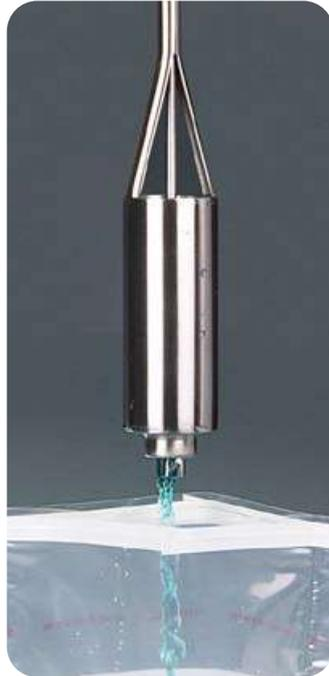
Pour vider l'échantillon, il suffit d'ouvrir la vanne avec le pouce.
