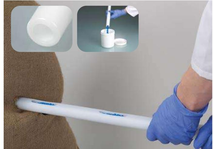
Collecteur zonal à usage unique pour le prélèvement d'échantillons de plusieurs couches du produit à échantillonner. Approprié pour les poudres fluides et les granulés à fine granularité. L'échantillon toutes couches représentatif peut être vidé directement à travers la poignée - ouverte dans un récipient à échantillons.
