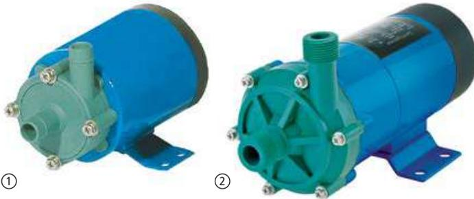
Les pompes centrifuges à entraînement magnétique sont adaptées pour le refoulement d'acides, de bases, de bains alcalins et galvaniques, de substances photochimiques ainsi que de liquides radioactifs, stériles et hautement corrosifs. Grâce à l'entraînement par transfert de forces magnétiques sans contact, aucune boîte d'étanchéité dynamique n'est requise, le carter de la pompe est hermétique et ne permet aucune fuite.
