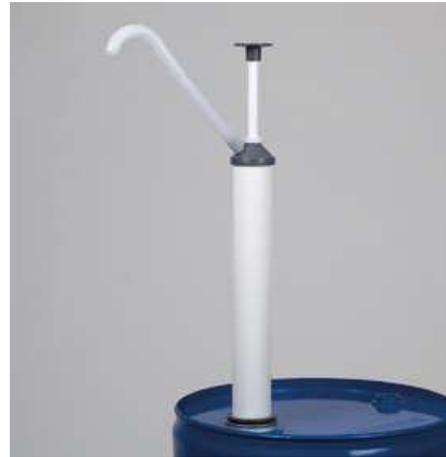
Pompe à piston pour produits aqueux et pétrochimiques. Elle offre un bon rapport qualité-prix. La pompe à piston est fixée au récipient de transvasement à l'aide d'un filetage 2" ou 3/4". Après le montage, la pompe peut tourner autour de son axe, permettant ainsi de placer les réservoirs de transvasement également sur le couvercle de fût.
