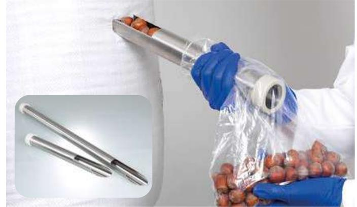
Echantillonneur pour produits en vrac coulants dont le diamètre n'excède pas 1 cm. Il permet par exemple de procéder à l'échantillonnage ciblé de noisettes, de mélanges de thés ou de céréales dans de grands sacs.
