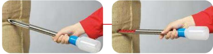
Le pic pour sacs QuickPicker est spécialement adapté lorsque les produits sont prélevés directement depuis des sacs ou des BigBags et remis sans délai dans le flacon d'origine. QuickPicker est d'usage et de nettoyage aisés. En l'absence de rainures et d'arêtes, aucun résidu d'échantillons n'est susceptible de fausser les prélèvements ultérieurs, il est donc idéal pour le contrôle qualité.
