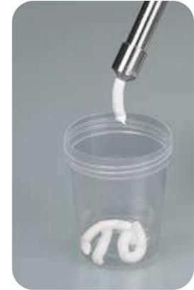
Préleveur pour substances visqueuses telles que pâtes, boues, crèmes, huiles. Le piston permet d'aspirer l'échantillon et de l'expulser directement dans un récipient collecteur. Nettoyage facile pour un prélèvement irrécusable. Selon le degré de viscosité, la pointe d'aspiration dévissable peut être livrée avec un perçage de 2 à 6 mm.
