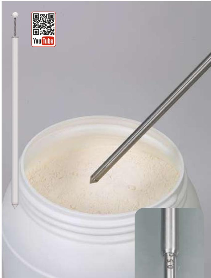
Le MicroSampler a été spécialement conçu pour collecter de petites quantités de poudre. Des volumes de 0,2 ml, 0,5 ml, 5,0 ml et 10 ml peuvent être prélevés dans les sacs ou récipients, à différentes profondeurs, de façon simple, rapide et propre. Les pointes du Micro-Sampler sont amovibles. Il est donc possible d'utiliser des pointes de différents volumes.
