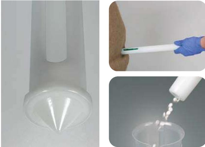
Avec TargetDispo, un échantillon ciblé est prélevé à une position précise prédéterminée du produit à échantillonner. Le collecteur est inséré fermé dans la poudre ou le granulé et ouvert puis refermé seulement au point de prélèvement. On obtient ainsi un échantillon ciblé exact. L'échantillon peut ensuite être vidé simplement par le biais de la poignée ouverte.
