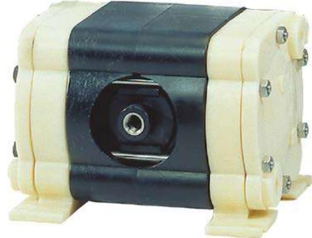
Pompe pneumatique à membrane pour transférer les fluides visqueux, corrosifs et abrasifs. Modèle de pompe 1/4". La pompe est disponible en polypropylène, PVDF et nylon. Les membranes, billes et sièges sont disponibles en Geolast, PTFE et santoprène. Des particules solides jusqu'à 1,6 mm  $\varnothing$  peuvent être pompées.
