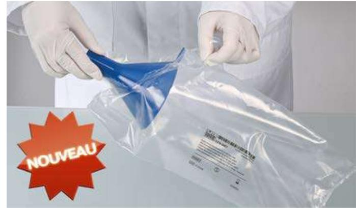
L'entonnoir à poudre à usage unique a un écoulement court et large, il est approprié pour le transvasement d'échantillons et de matériaux pulvérulents, de granulés, de suspensions mais aussi d'autres liquides.
