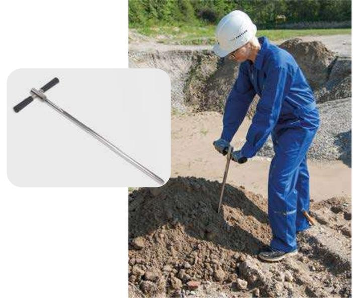
Echantillonneur Pürckhauer très robuste pour sols lourds et caillouteux. La pointe conique d'au moins 60 cm (modèle 5350-5018) permet un retrait plus simple du préleveur lorsqu'il est enfoncé dans le sol. Idéal également pour le prélèvement N-min 0–90 cm.
