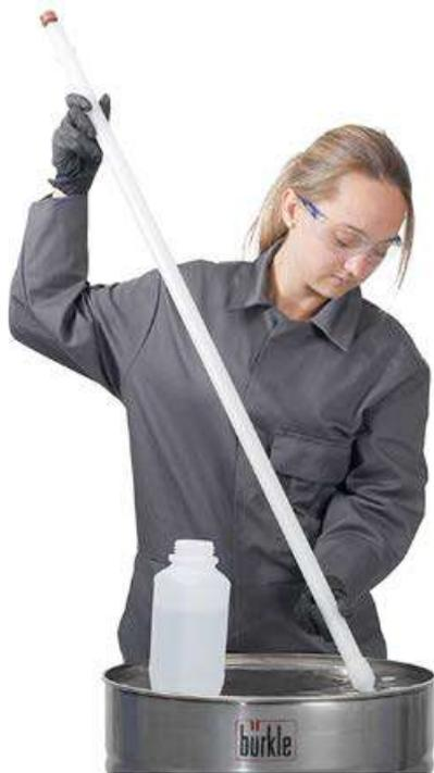
LiquiSampler, l'échantillonneur pour liquides, conforme à la norme DIN EN ISO 15528. En PTFE/FEP ou PP ultra-pur et chimiquement inerte pour un échantillonnage sans contamination. Prélèvement depuis des récipients ouverts ou fermés, des fûts, des citernes, des silos, des plans d'eau. Il est adapté à tous les fûts et récipients courant avec un diamètre d'ouverture d'au moins 32 mm.
