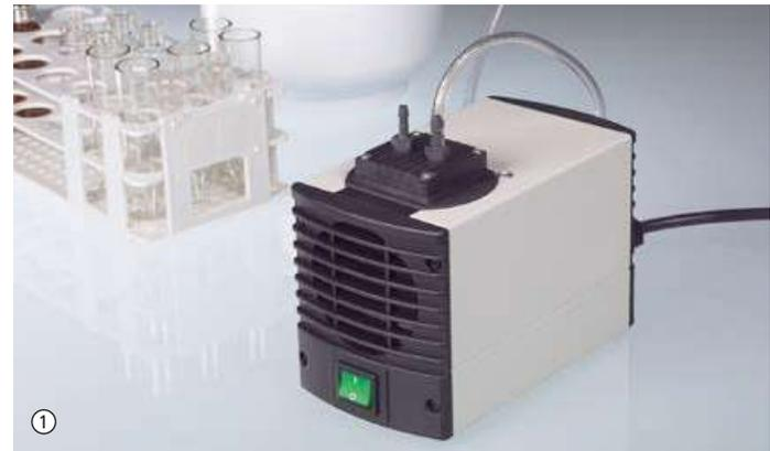
La pompe à vide à membrane à une tête AirJet Mini convient à de nombreuses applications en laboratoire et dans l'industrie. Fonctionnant à sec, elle comprime et évacue les fluides absolument sans huile, évitant ainsi de les contaminer ou de les souiller, ce qui permet de l'utiliser également en guise de compresseur.
