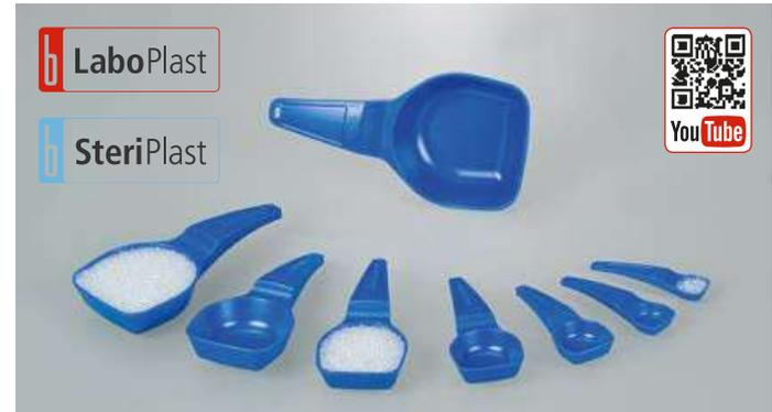
Les cuillères-mesures et les cuillères doseuses permettent de mesurer et de doser exactement de petites quantités de poudre, de granulés et de liquides. Pour une mesure précise, il suffit d'éliminer l'excédent sur le rebord supérieur de la cuillère.
