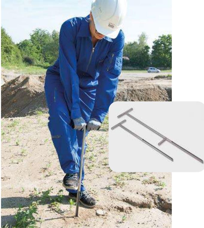
Echantillonneur pour des sols meubles, de l'herbe et des pelouses. Le repose-pied du modèle 5350-5006 simplifie significativement les travaux.
