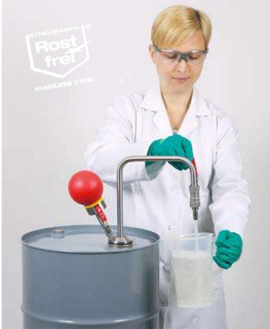
Pompe à solvant à commande manuelle pour prélèvement stérile de solvants et arômes organiques. La pompe à main fonctionne selon le principe de la surpression. La balle de pompe permet d'obtenir une surpression à l'intérieur du récipient, poussant le liquide vers l'extérieur.
