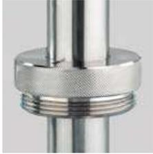
Filetage en laiton nickelé pour la pompe vide-fût en inox. Empêche la charge électrostatique par l'emploi du lot antistatique. Pour le transvasement sûr de liquides facilement inflammables. Pour réservoirs avec filetage acier fin R 2".
