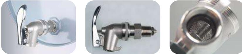
Robinet de fût stable et robuste en acier inoxydable V2A (1.4301). La sortie du robinet de fût peut pivoter à 360° et peut ainsi être réglée sur chaque position requise. Avec un dispositif d'accrochage pratique pour le réservoir de tireuse et des œillets pour fermer le robinet de fût.
