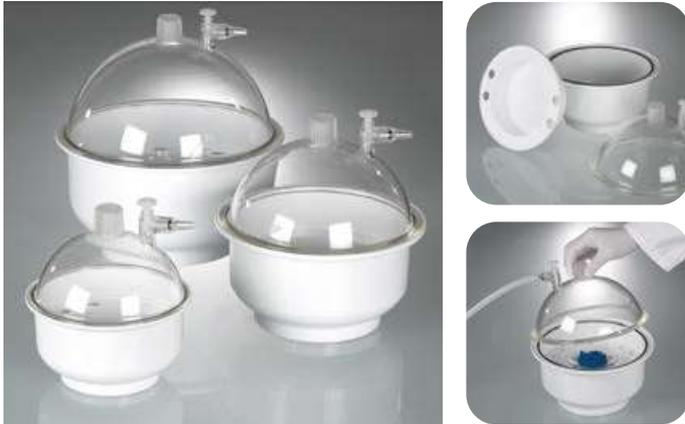
Dessiccateurs en matière plastique, incassables, légers et fonctionnant sous vide. Le robinet est adapté à un vide jusqu'à -740 mmHg. Partie inférieure et insert perforé en polypropylène. Couvercle en polycarbonate transparent avec clapet anti-retour et vanne de purge. Etanchéité par joint torique en caoutchouc polychlorobutadiène. Température en service continu +60 °C max.
