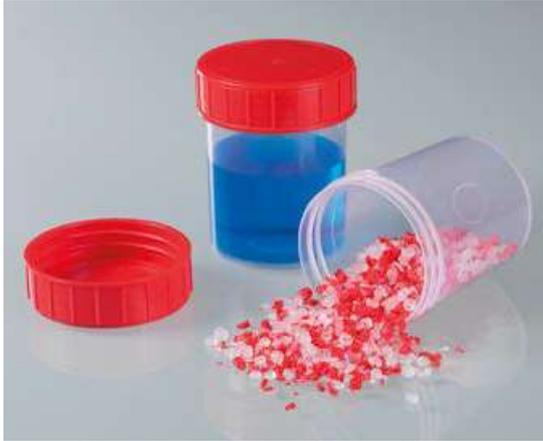
Bécher d'échantillonnage avec couvercle rouge étanche. Les béchers d'échantillonnage sont aseptiques et conviennent aux denrées alimentaires. Sans couvercle, les béchers sont stérilisables en autoclave.
