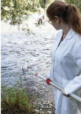
Le puisard à tige télescopique est un système de prélèvement disposant de multiples équipements pour des applications diverses. Les équipements (bêcher à angle variable, bêcher sur balancier, porte-flacons, bêcher en inox et épuisettes) sont raccordés par encliquetage sur la tige télescopique.
