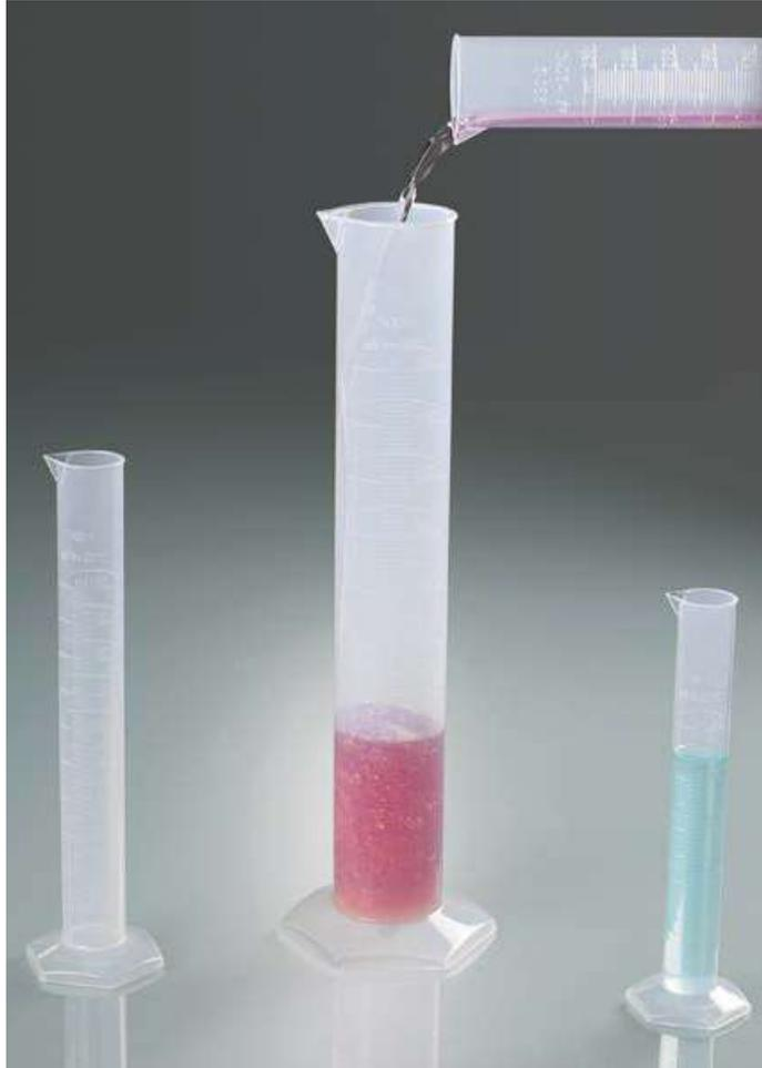
Cylindre de mesure, forme haute, selon DIN 12681 (verre) / ISO 6706 avec base hexagonale. Pour une utilisation en laboratoire, en pharmacie, dans des ateliers, lors d'études sur le terrain et partout où des productions doivent être mesurées d'un point de vue volumétrique.
