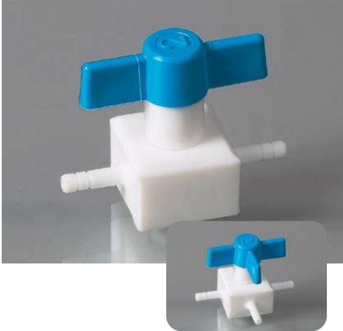
Vannes deux voies / trois voies en PTFE massif avec embouts de tuyaux. Résistantes aux produits chimiques. Sans frottement grâce aux excellentes propriétés de glissement. Poignées bleues en PP.
