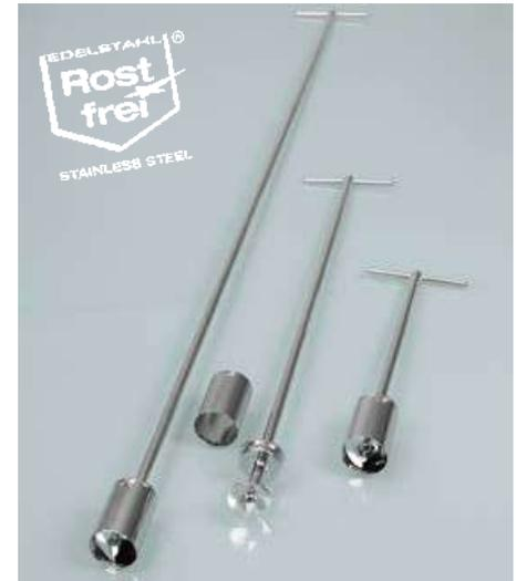
Préleveur conçu pour le prélèvement de produits surgelés, fortement visqueux et pâteux, comme par ex. la glace alimentaire et substances analogues. La lame en forme de foret pénètre d'elle-même le produit surgelé. Le cylindre collecteur est facile à retirer grâce à l'accouplement à baïonnette. L'échantillon est alors libéré et peut être retiré.
