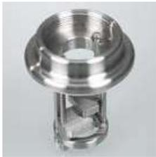
Adaptateur fileté universel pour quasiment tous les fûts et autres récipients avec une ouverture de 48-75 mm de diamètre, indépendamment du filetage existant. L'adaptateur fileté peut être monté facilement et rapidement avec les vis de serrage et peut être utilisé pour diverses ouvertures de récipient. Avec le filetage de raccordement G2" pour les raccords filetés de fût et les pompes avec un diamètre de tube immergé jusqu'à 32 mm.
