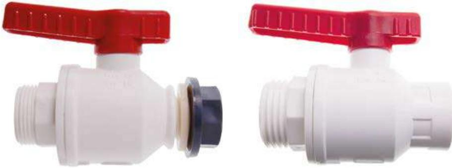
Robinet à bille en PP avec filetage extérieur / intérieur, à renfort en fibre de verre, bille en PP, poignée avec joint torique en NBR apte au contact alimentaire et joint en HDPE.
