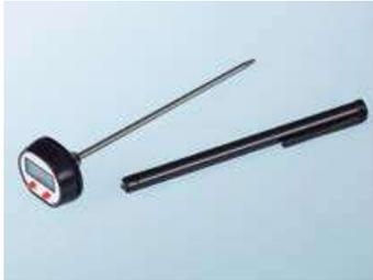
Le thermomètre à sonde permet de saisir la température des gaz, des substances molles ou poudres et liquides. Nouveauté : Le thermomètre miniature imperméable peut être facilement nettoyé à l'eau courante, voire même en machine.
