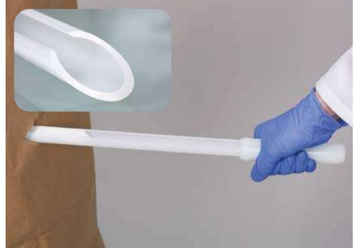
PowderDispo est l'échantillonneur à usage unique idéal pour les échantillons de section de substances pulvérulentes ou légèrement corrosives. Avec la lance, il est possible de prélever un échantillon toutes couches de sacs ou de petits récipients.
