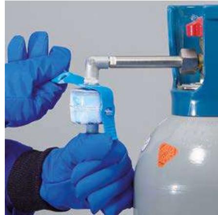
n'importe quelle bouteille de CO<sub>2</sub> européenne en acier avec conduite montant sans détendeur (W 21,80 x 1/14» selon DIN 477-1 N° 6), utilisée couramment dans de nombreuses entreprises et laboratoires. Une bouteille peut sinon être louée auprès d'un commerce local spécialisé contre une somme modérée.
