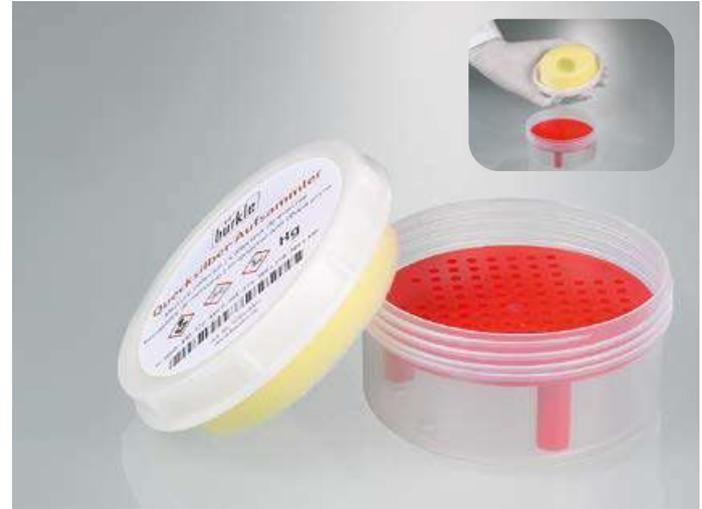
Le collecteur de mercure Bürkle permet de collecter le mercure déversé et de le réutiliser. Le collecteur de mercure est constitué d'une boîte avec un insert spécial en mousse expansée collé dans le couvercle vissé. Lorsqu'on appuie sur l'insert en mousse alvéolée sur le mercure déversé, les pores s'ouvrent et aspirent les billes de mercure. Lorsqu'on visse le couvercle, les billes se détachent et tombent dans la boîte à travers le disque de séparation perforé.
