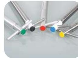
Code couleur : Détrompage pour les échantillonneurs Multi et Uno.
