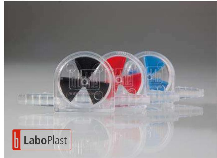
L'indicateur de débit CheMobil en polyméthylpentène peut être utilisé pour de nombreux fluides en raison de sa bonne résistance chimique. Ne pas utiliser pour des acides forts, des bases fortes et des solvants. Che-Mobil est stérilisable à la vapeur.
