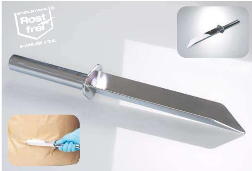
Spatule à échantillons en acier inoxydable V4A (1.4404). La construction très stable et massive de la spatule permet également d'inciser des substances solides ou des sacs et des BigBags. La spatule en acier inoxydable de haute qualité est polie miroir et complètement soudée, et ainsi partout exempte de fissures. Elle est parfaitement appropriée pour la prise d'échantillons de poudres, de granulés et de fluides pâteux, en particulier dans le domaine agroalimentaire et pharmaceutique.
