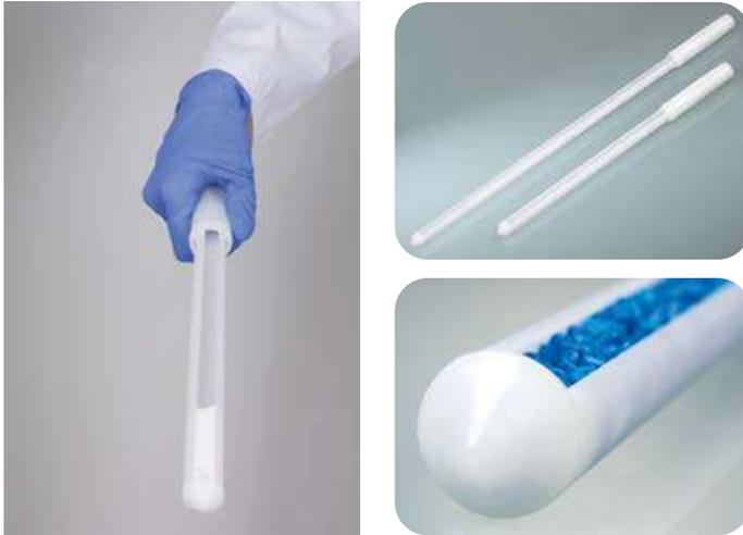
Échantillonneur à usage unique pour les produits en vrac pulvérulents et à petite granularité. Grâce à la pointe fermée, l'échantillon ne peut pas couler de nouveau hors de la lance d'échantillonnage. DispoPicker est idéal pour les échantillons de section.
