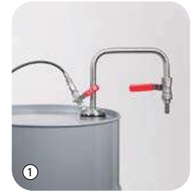
Ce système de prélèvement pour solvants permet de transvaser rapidement et aisément des liquides ultra purs. Un gaz sous pression (air comprimé ou azote) permet d'obtenir une surpression à l'intérieur du récipient, poussant le liquide vers l'extérieur. L'avantage de la commande via gaz sous pression réside dans le fait que l'utilisateur peut facilement prélever même de grandes quantités tout en ayant les deux mains libres pour transvaser le solvant.
