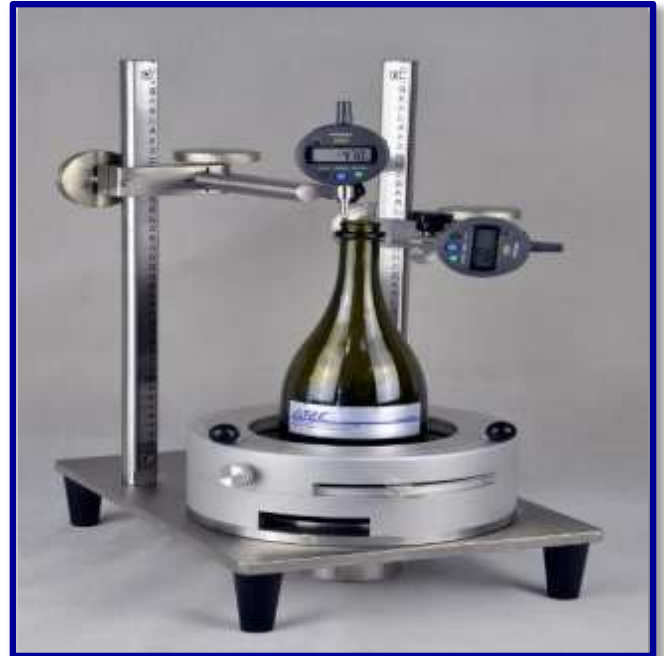
UBPT-2 avec mesure de planéité buvant et perpendicularité
