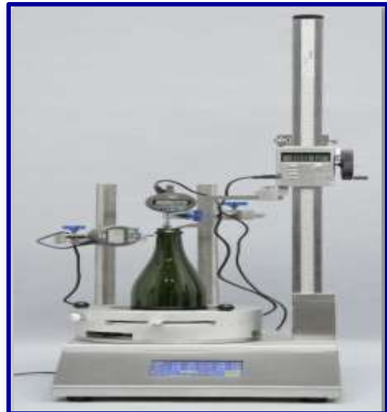
UBPT-2 avec mesure de planéité buvant et perpendicularité
