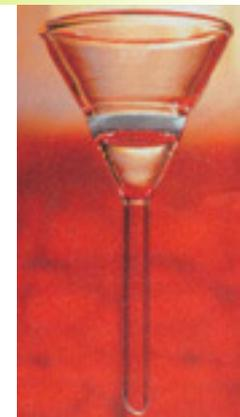
DURAN Creusets filtrants de porosité 1 à 4 et de capacité de 50 à 400 ml.
