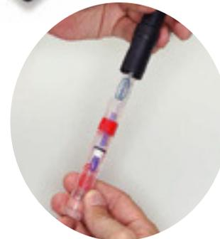
Les manchons d'étalonnage sont fournis avec seulement 2 ml de solution tampon et vissés directement sur l'électrode de manière parfaitement étanche. Ceci facilite l'étalonnage sur le terrain et garantit un stockage plus sûr des électrodes, même pour une période prolongée.
