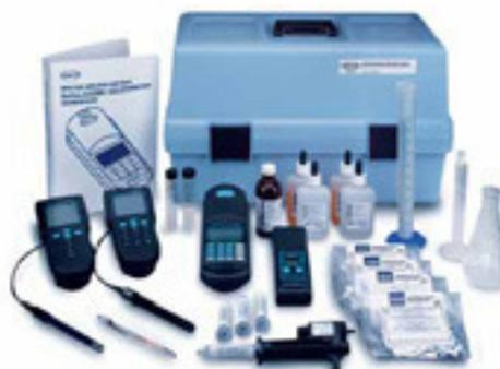
Les colorimètres de la gamme DR 800 sont au cœur du coffret d'analyse CEL. Ils sont configurés pour différentes gammes de paramètres.
