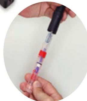
Les manchons d'étalonnage sont fournis avec seulement 2 ml de solution tampon et vissés directement sur l'électrode de manière parfaitement étanche. Ceci facilite l'étalonnage sur le terrain et garantit un stockage plus sûr des électrodes, même pour une période prolongée.
