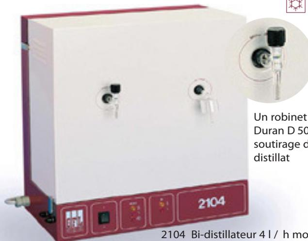
Un robinet en verre Duran D 50 permet le soutirage de mono-distillat
