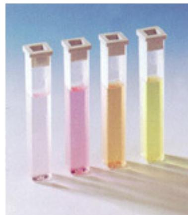
Cuves plastiques, dépolies sur deux faces, volume 10 ml, trajet optique 13,5 mm, avec capuchon.
