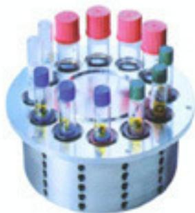
Les matériaux spécial du HT 200S permet la minéralisation et le refroidissement rapide de 12 tests en cuves ou cuves de réaction en simultané.
