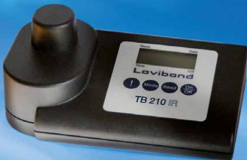
Turbidimètre compact TB 210 IR pour les analyses rapides et exactes sur le terrain. Comme le prévoit la norme EN ISO 7027, il mesure la lumière diffusée dans un angle à 90°.
