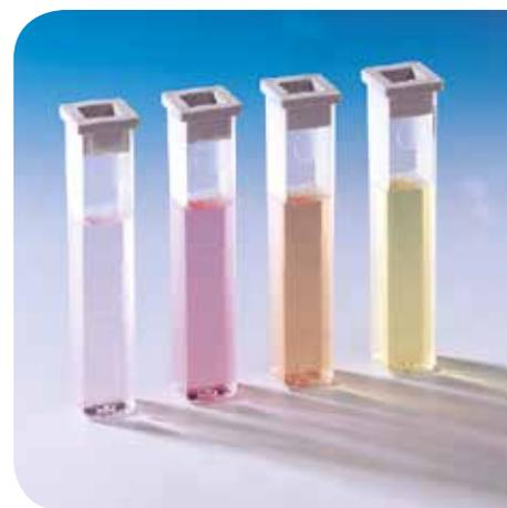
Cuves plastiques, dépolies sur deux faces, volume 10 ml, trajet optique 13,5 mm, avec capuchon
