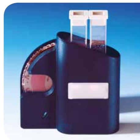
Vue de l'arrière du comparateur CHECKIT®, avec disque, plaque de diffusion et cuves
