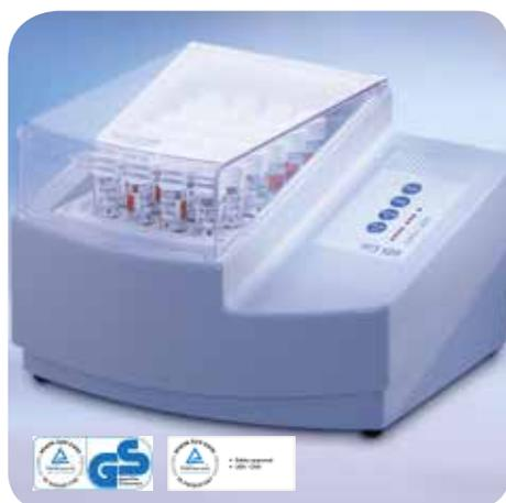
La digestion chimique des échantillons est un préalable pour, parmi d'autres tests, la détermination de la DCO, COT, phosphate total et azote total.
