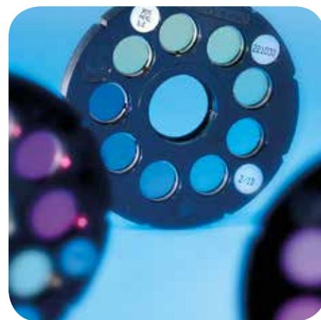
Disque de test avec étalons de verre à couleur stable
