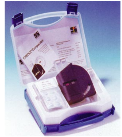
Kit d'analyse pour comparateur CHECKIT complet avec mallette de transport, prêt à l'emploi
