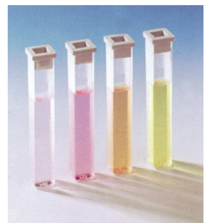
Cuves plastiques, dépolies sur deux faces, volume 10 ml, trajet optique 13,5 mm, avec capuchon.
